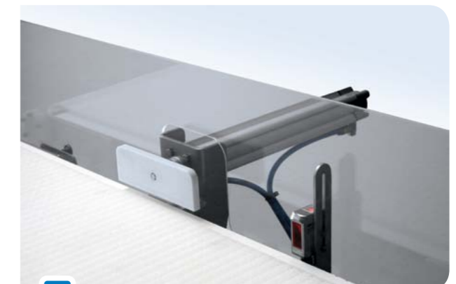
Pneumatik-Pusher als ein mögliches Ausschleuse-Organ des Detektionssystems.
