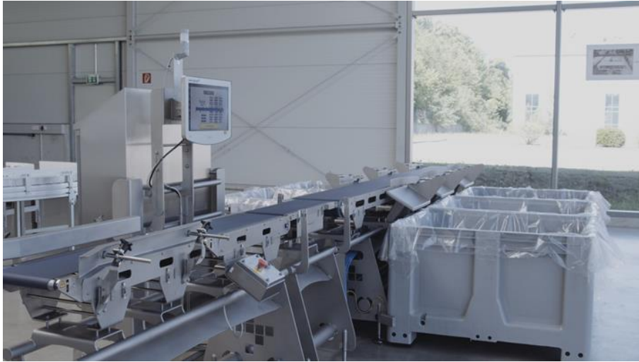
Abb. 1 Höfelmeyer Sortierwaage zum vollautomatischen Klassifizieren von Produkten
