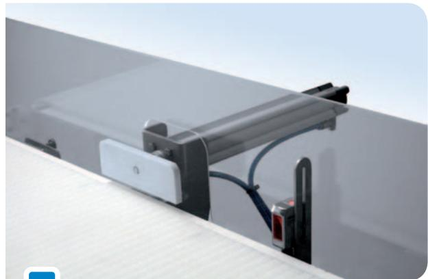
Pneumatik-Pusher als ein mögliches Ausschleuse-Organ des Detektionssystems.
