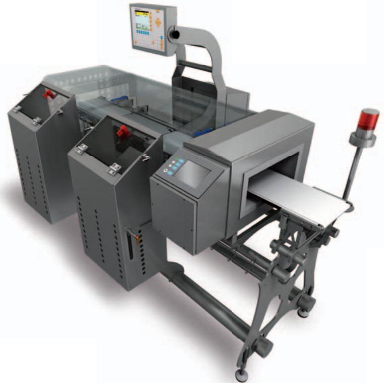
Als Kombinationssystem mit einem Metallsucher wird die volle Inspektion nach BRC-Standard gewährleistet. Zusätzlich wird durch eine Abdeckung der Bänder ein Zugriff auf die Produkte verhindert.
