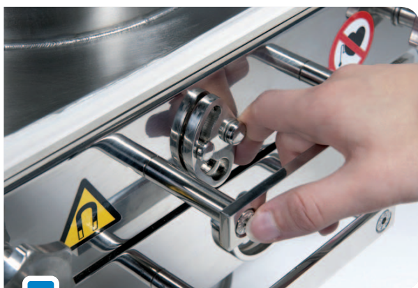
Riegelfallen-Verschluss, um die Magnetkerne aus den Edelstahlhülsen ziehen zu können Einfache Abreinigung.
