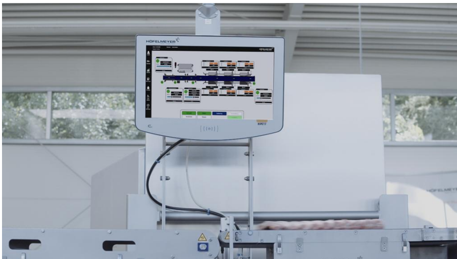
Abb. 2 Höfelmeyer Grader mit modularem Softwarepaket einschl. kundenangepasster Visualisierung und Bedienung
