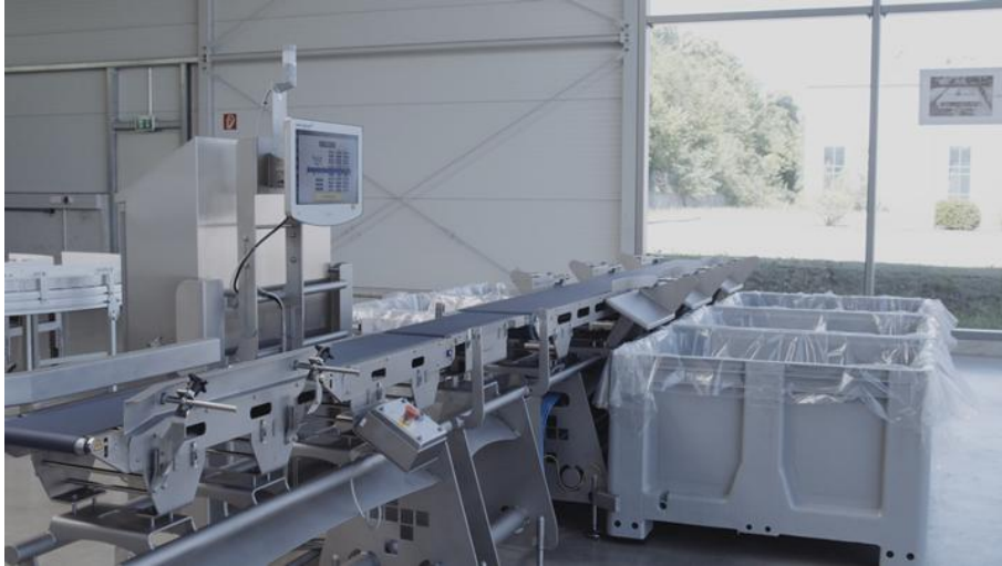
Abb. 1 Höfelmeyer Sortierwaage zum vollautomatischen Klassifizieren von Produkten
